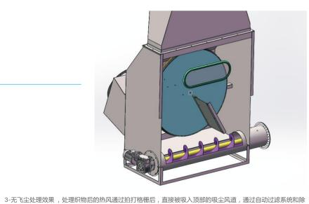
4-最佳的经向预缩效果,在撞向拍打格栅前,织物在风道中由上下两股热风气流托举 左右运动,处于绝对的松弛状态,从而使织物获得完美的预缩效果;并且由于织物没 有与任何物体摩擦,避免起球。
